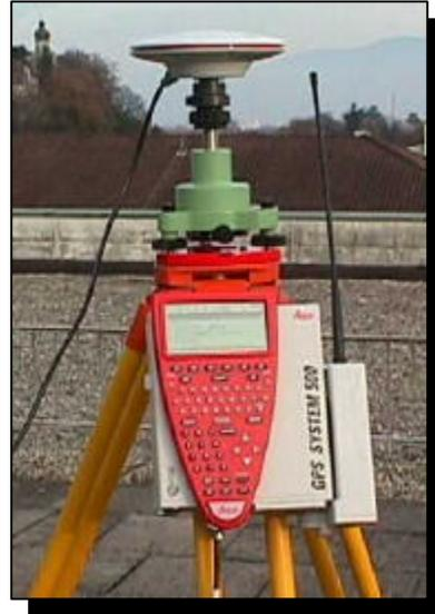
Los posicionamientos posibles con estos equipos son: Estático, Estático Rápido, Stop&Go, Cinemático y KOF como métodos de postproceso y además la posibilidad de realizar todos éstos en Tiempo Real. La principal ventaja con respecto a los equipos monofrecuencia con medida de fase es un aumento en la precisión hasta 5mm+1ppm y sobre todo una enorme disminución en los tiempos de observación. Las aplicaciones de estos equipos abarcan el mundo de la Topografía y la Geodesia.
